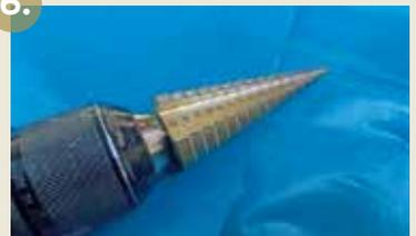
Mit einem Stufenbohrer nun ein Loch an einer entsprechend hohen Stelle in die Kanisterhälfte bohren. Hier das Schwimmerventil mit Dichtung einschrauben. Bohrlochgröße und Hahndurchmesser müssen zusammenpassen.
