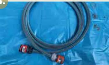
Zuerst wird der Schlauch auf die benötigte Länge geschnitten. Bitte genau ausmessen, denn sonst funktioniert das System am Ende nicht. Danach die beiden Kupplungsdosen an den Schlauchenden befestigen.
