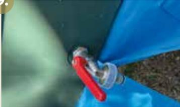
In den Vorratsbehälter ein Loch für den Absperrhahn bohren. Danach den Hahn mit einer Dichtung durch das Loch schieben und auf der Innenseite mit Dichtung und Mutter sichern. Wird ein Kanister verwendet, ist der Hahn im Schraubdeckel anzubringen.
