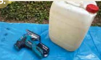
Der Kanister wird in der Höhe mit der Stichsäge mittig durchgesägt. So entstehen zwei flache Hälften. Die rauen Sägekanten mit einem Messer entgraten.
